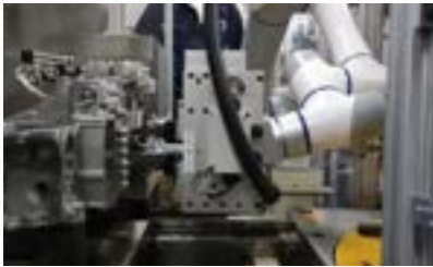
ギアボックスのねじ締め
