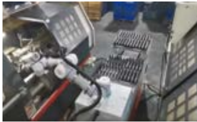
工作機械のロード/アンロード
