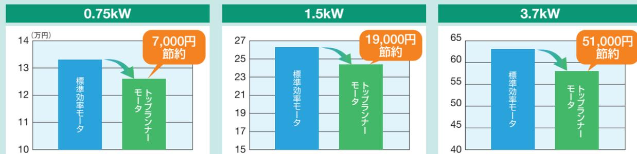
計算条件: 4P-200V-50Hz, 各1台, 負荷率100%, 運転時間8760時間/年, 電力料金16円/kWh, 回転速度差による影響は考慮していません。
