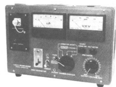
第 40 図 耐電圧チェッカ正面外観
