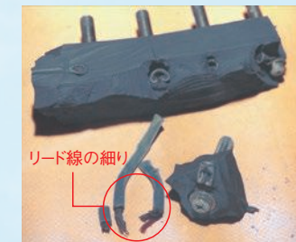
硫化銅腐食例(使用後約20年)
